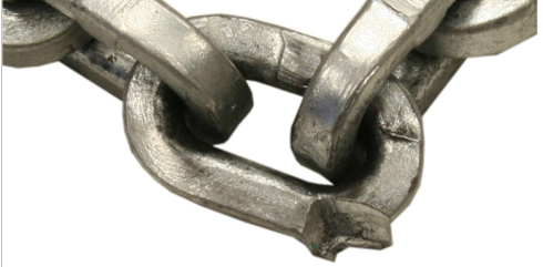
Zincir halkası, mekanik olarak hasar görmüştür.
